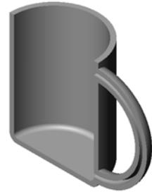
**Solución:** Utilice una operación Cortar para eliminar el material del interior de la taza.
