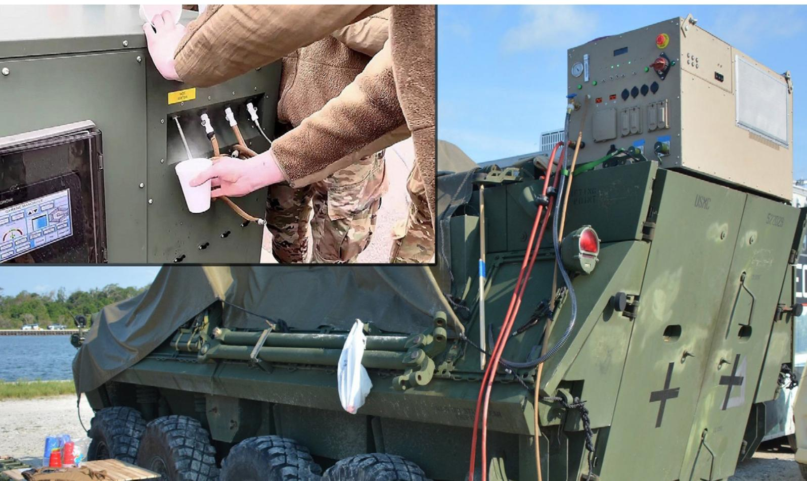
Usando as soluções de projeto, gerenciamento de dados, simulação, colaboração e comunicação do **3DEXPERIENCE Works**, a Gyrene desenvolveu sua inovadora Mangrove Vehicle Integrated Atmospheric Water Harvester para o Corpo de Fuzileiros Navais dos Estados Unidos. O sistema cria água a partir da atmosfera, mesmo em climas mais áridos, e ainda inclui um sistema de filtragem móvel que produz água potável purificada a partir de qualquer fonte hídrica, salgada, salobra ou contaminada por poluentes.
