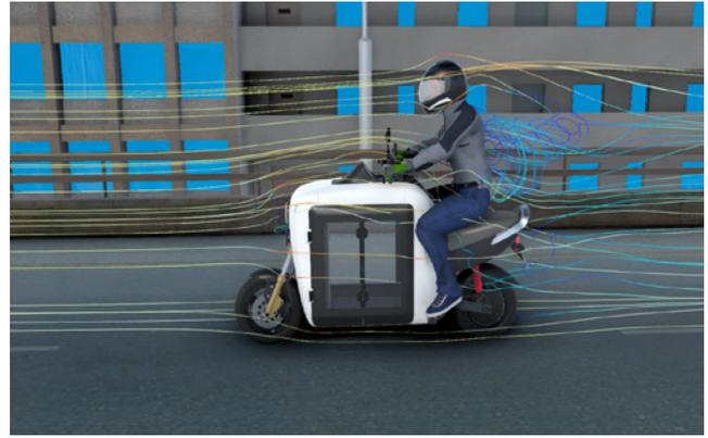
QARGOS a fait appel aux solutions de simulation multiphysique SIMULIA, notamment SIMULIA Fluid Dynamics Engineer, pour simuler les forces aérodynamiques qui s'exercent sur le conducteur et le scooter en usage, ce qui a permis de réduire l'incidence de la traînée et d'améliorer les performances du véhicule.
