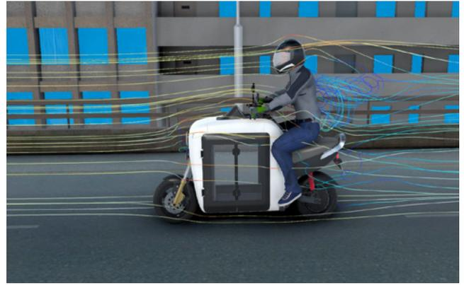
SIMULIA Fluid Dynamics EngineerなどのSIMULIAマルチフィジックス シミュレーション ソリューションを活用して、走行中に乗り手とスクーターの両方にかかる空力をシミュレーションし、空気抵抗を減らしつつ、スクーターの性能を向上させました。
