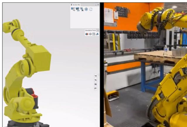
Uma vantagem importante da programação offline de robôs de produção com o aplicativo Robot Programmer Standard é a manutenção das operações do robô durante a programação da próxima tarefa, em vez de tirar o robô do ar para programá-lo, como era feito anteriormente.
