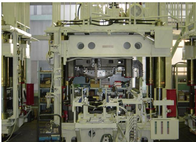
高津製作所の従来から主力製品であるプレスタイプのヘミング機。(写真) 最近の主流はローラーヘミング機。通常のヘミング機は1設備で1車種を生産するが、同社の汎用ローラーヘミング機は1設備で4車種に対応。1つの生産ラインで複数車種を組み合わせることで効率よく生産する変種変量ラインを可能にした。また、省スペースおよびランニングコスト低減においても優れている。
