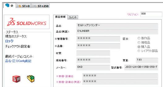
PDM上に登録をしている購入部品の使用例(写真上)属性には『製品名、型式、メーカーなど』必要な情報をインプットすることで(写真下)手配用リスト作成の効率化に繋げている。また、『区分』により権限をもうけ編集ミスによる書き換え防止を行っている。
