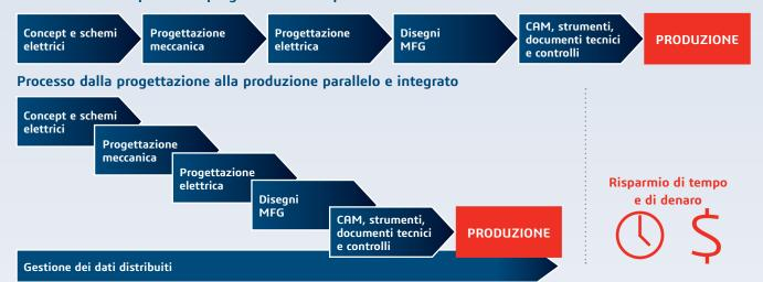
Al centro di questa soluzione, un modello CAD 3D condiviso che permette una gestione efficace delle modifiche in termini di progettazione e produzione e la propagazione automatica a tutti i disegni, i sistemi di produzione a valle e i documenti tecnici correlati influenzati dalle variazioni apportate.
