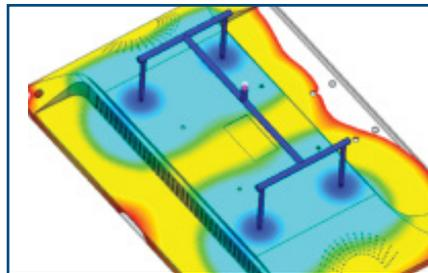
Führen Sie eine Analyse des Kunststoffspritzgusses durch, um Anschnittpositionen zu optimieren und die Positionen der Bindenähte und Luftpneinschlüsse vorherzusehen.
