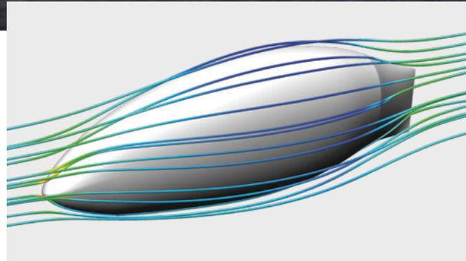
“借助 SOLIDWORKS Flow Simulation,我们获得了重要的洞察力,并开发了关键的创新技术来帮助我们大幅提升整流装置的空气动力学性能,”Aerovelo 联合创始人 Cameron Robertson 说,“我们使用 SOLIDWORKS Flow Simulation 压力分布来推进我们的空气动力学策略。层流显然比湍流拥有更好的性能,我们希望获得尽可能更多的层流。但是,要创建能够更多地实现自然层流的整流装置形状,需要采用极为巧妙和精细的设计方法,在这方面,SOLIDWORKS Flow Simulation 软件可以为我们提供帮助。”
