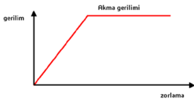
Şekil 6: Tam elastik plastik bir malzeme modelinin gerilim-zorlanma eğrisi. Bu malzeme modeline göre maksimum gerilim boyutu plastik gerilimi (akma gerilimi) limitini aşamaz.
