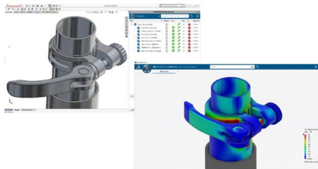
Transfira recursos de geometria e modelo do SOLIDWORKS para o Structural Performance Engineer com um único clique a fim de executar estudos de simulação avançados.
