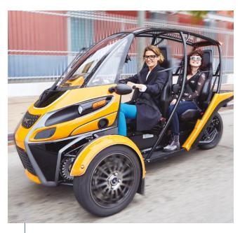
A Arcimoto aproveitou as ferramentas de projeto de chapa metálica do SOLIDWORKS Premium para criar um chassi de chapa metálica multicorpos para o seu FUV, ajudando a montadora a alcançar suas ambiciosas metas de resistência, rigidez e redução de peso.
