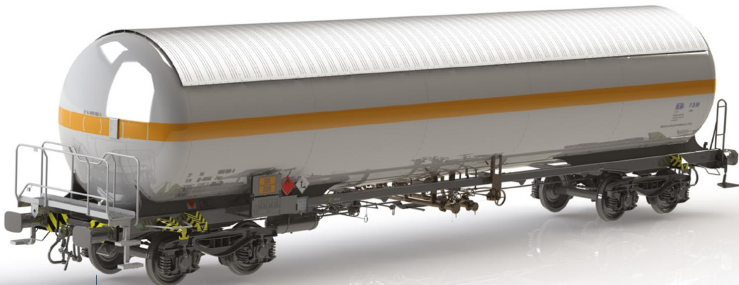
Astra Rail 依靠 SOLIDWORKS 设计和 FEA 分析工具来加快其轨道油罐车、货车和转向架的开发并提高性能,包括此处展示的液化石油气 (LPG) 油罐车。
