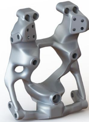
휠, 브레이크 로터, 허브, 브레이크 캘리퍼, 스티어링 암을 차량에 부착하는 서스펜션 업라이트(혹은 너클)부터 시작하여 Giaffone Racing은 SOLIDWORKS Simulation Professional 토폴로지 스터디 기능을 통해 브라질 스톡 카 시리즈의 새 부품을 설계합니다. SOLIDWORKS 토폴로지 스터디를 통해 Giaffone은 이 부품을 최적화하여 강성을 유지하면서도 무게를 줄였습니다.
