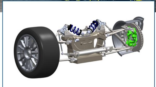
SOLIDWORKS 토폴로지 스터디를 통해 설계 엔지니어는 최적화된 부품 지오메트리를 자동으로 생성함으로써 특정한 설계 공간, 하중 및 지오메트리 구속 조건(제조 프로세스에 의해 적용되는 구속 조건 포함)에 기초하여 무게-강성 비율의 균형 맞춤, 질량 최소화, 최대 변위 최소화 등 주어진 목표를 충족할 수 있습니다.
