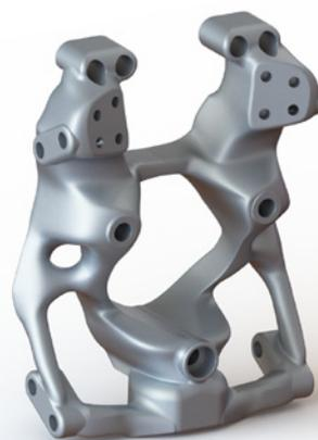
Com a capacidade de estudo topológico do SOLIDWORKS Simulation Professional, a Giaffone Racing está projetando novos componentes para a stock car brasileira, começando com a junta da suspensão (apresentada aqui) que prende a roda, o rotor do freio, o cubo, a pinça de freio e o braço de direção ligado ao veículo.
