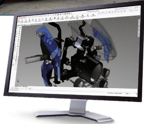
Además de utilizar el software SOLIDWORKS Premium para desarrollar motocicletas personalizadas completas, Kenstomoto diseña a medida subsistemas y accesorios de motocicletas, como sistemas de faros y juegos de cubiertas, que los clientes utilizan para sustituir los sistemas de fábrica que vienen con las motocicletas existentes.
