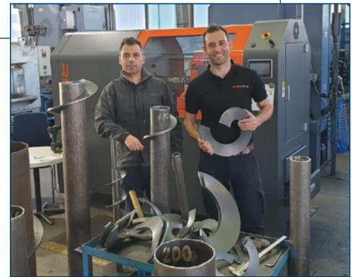
Com os recursos de simulação do SOLIDWORKS, os engenheiros da RoboHelix conseguiram aplicar a força necessária e direcioná-la corretamente para obter a deformação controlada através da qual a máquina robótica de formação de taliscas esticaria um disco de metal para formar um helicoido.
