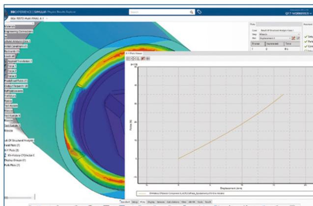
En plus d'utiliser SIMULIAworks pour effectuer des analyses non linéaires de grands déplacements, les ingénieurs SGA peuvent également s'appuyer sur la plate-forme basée sur le cloud pour générer des résultats précis pour toute une gamme d'autres problèmes techniques difficiles, tels que la simulation de rétrécissement/contrainte résultant des variations thermiques et celle de pré-compression due à la plastification de l'acier.
