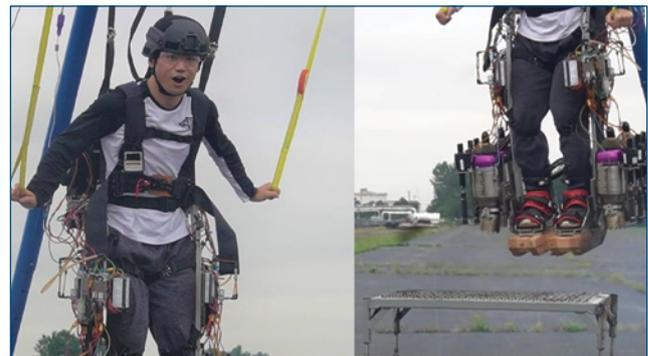
Mithilfe von SOLIDWORKS Studien zur Topologieoptimierung für die Gewichtsreduzierung von Komponenten und SOLIDWORKS Flow Simulation Tools zur Optimierung der Form der patentierten Schubvektordüse für die vier Düsenantriebe – zwei pro Bein – konnte Exovolar durch die Simulation der Konstruktionsleistung und die Optimierung der Konstruktion mit SOLIDWORKS den ersten Schwebetest ohne überflüssige Prototyping-Runden absolvieren.
