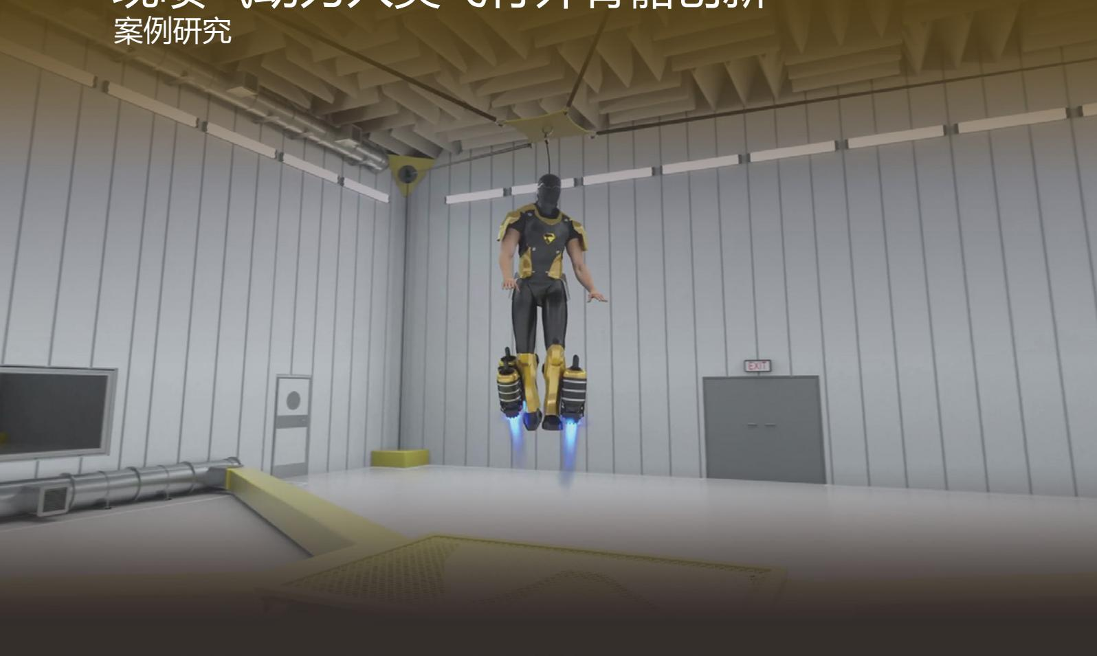
Exovolar 利用 SOLIDWORKS for Entrepreneurs and 3DEXPERIENCE Works 解决方案开发了其喷气动力外骨骼，与以前的喷气背包设计不同，这种外骨骼利用双腿进行飞行和导航，让用户在悬停位置时可腾出双手完成任务。
