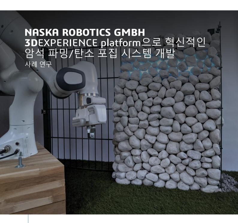
NASKA ROBOTICS는 기후 변화의 영향에 맞서기 위해 이산화탄소를 광화하는 RockFarm 로봇 시스템 연구 개발을 완수할 수 있도록 클라우드 기반 **3DEXPERIENCE** platform을 활용하고 있습니다. 로봇 시스템이 암벽을 세우고 이산화탄소를 흡수하는 암석 입자(20마이크론보다 작은 크기)로 암벽을 채운 후, 암석 배지의 탄소가 포화되면 물로 벽을 헹구고 탄소를 흡수하는 새 암석 분말로 다시 벽을 채우게 됩니다.
