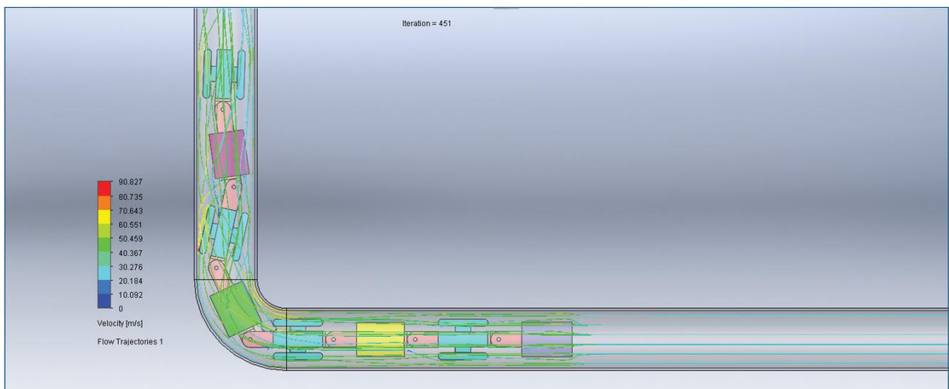
Utilizzando gli strumenti di progettazione e simulazione SOLIDWORKS, ULC Technologies ha creato una rete di condutture virtuali per i test di simulazione per assicurarsi che il robot in linea potesse avanzare lungo le curvature e attraverso ostacoli come le valvole, eliminando mesi di tempo dal lavoro di sviluppo e centinaia di ore di prototipazione con relativi costi durante il processo.
