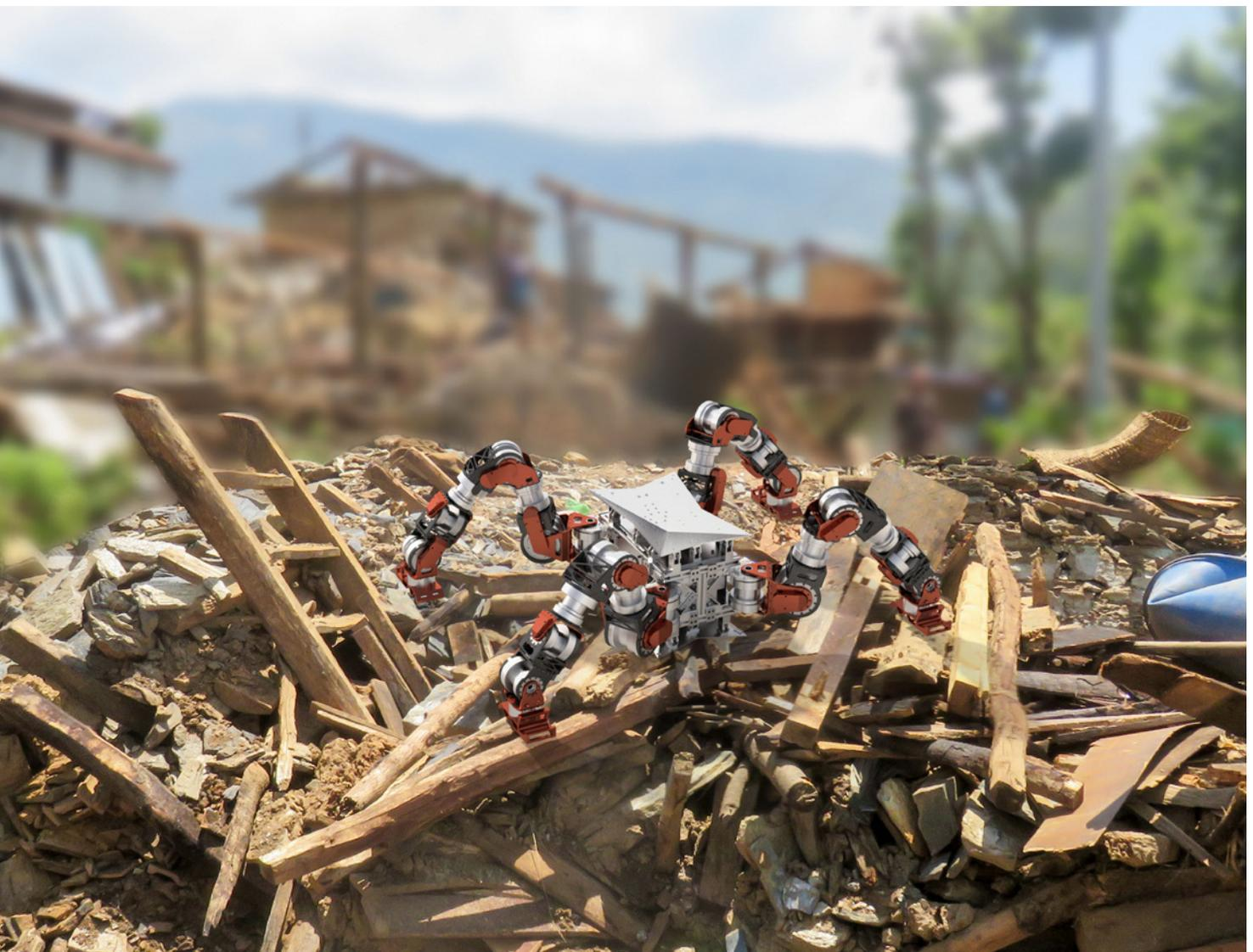
自 2001 年以来, 早稻田大学的仿人机器人研究所 (HRI) 一直依赖于 SOLIDWORKS® Research 设计和工程软件, 来加速机器人开发的步伐。在此期间, HRI 推出了 20 款仿人机器人, 其中包括 WAREC-1 灾难机器人(如图所示), 它有 28 个自由度。
