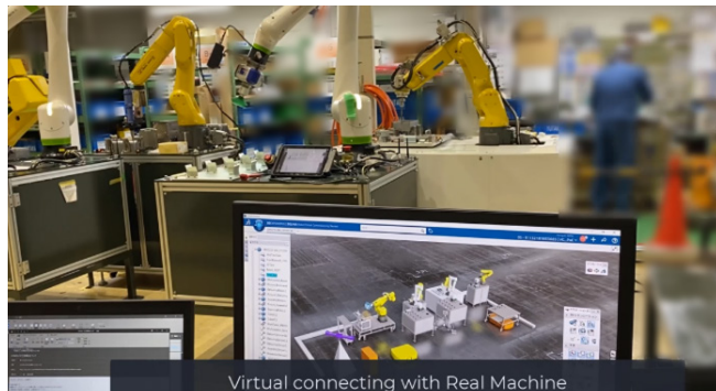
バーチャルの製造ラインを実機に接続
