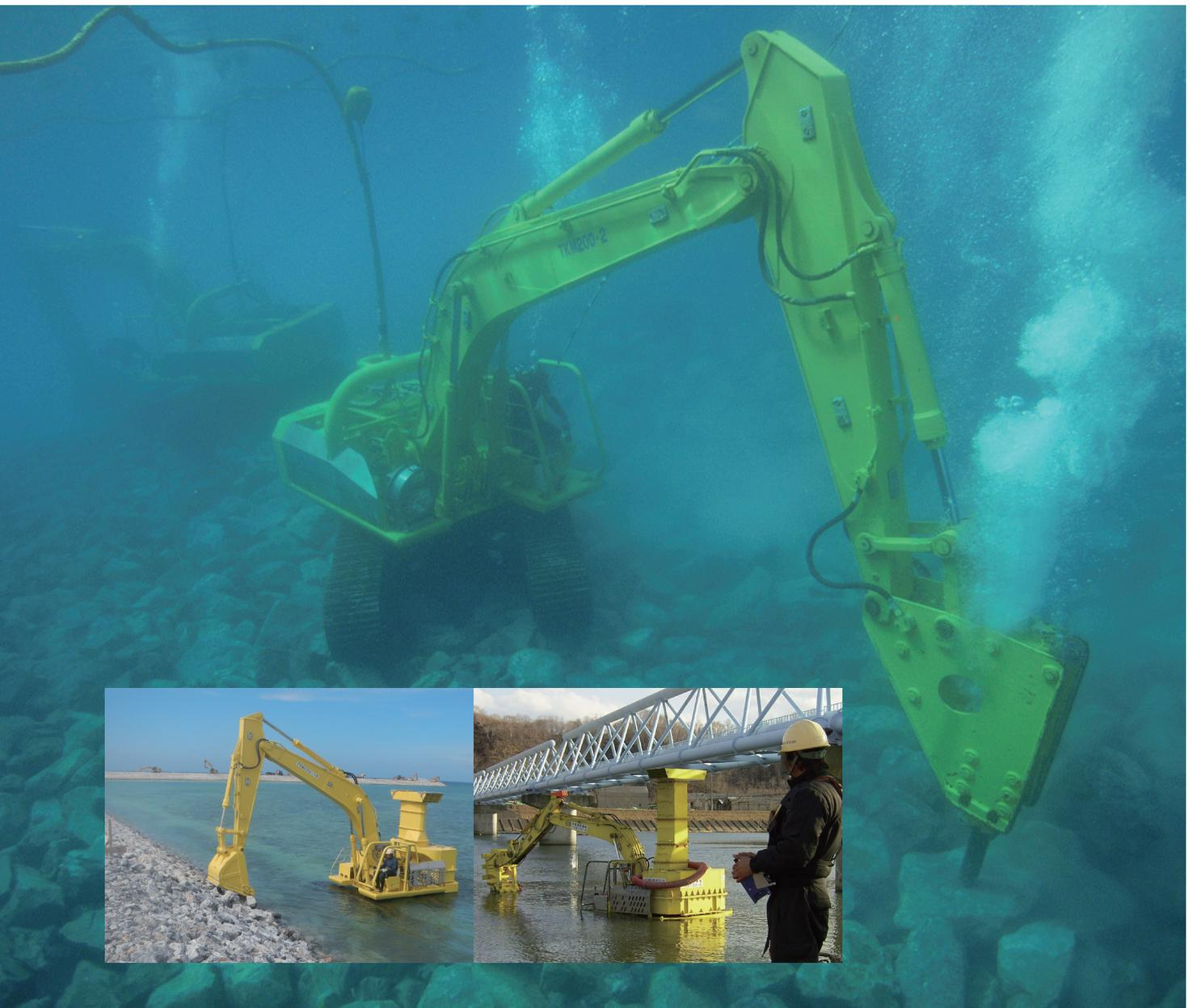
沖縄県那覇市に本社を置く極東建設株式会社は潜水作業の施工会社である。作業効率化と潜水士の安全性確保の目的で、建設機械のバックホウを水中で使えるように自社開発してしまった。沖縄発の最新土木技術が、水中工事に大きな変革をもたらしつつある。
