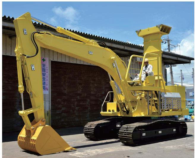
水圧に適応するためには、耐圧か均圧の構造が必要。海中で使う機器はサビとの戦いも厳しい。サビ落としをするたびに鉄は削られて薄くなっていくので、3ミリの厚さに、「サビしろ」を6ミリ足して、9ミリ厚にしているほどだ。
