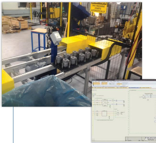
Le logiciel SOLIDWORKS Electrical 3D permet à CNC Solutions de créer une nomenclature unifiée et d'utiliser une base de données commune pour les symboles électriques. L'entreprise améliore ainsi la qualité, la précision et l'apparence de ses schémas électriques tout en réduisant le nombre de reprises nécessaires et en accélérant la création des informations de nomenclature.
