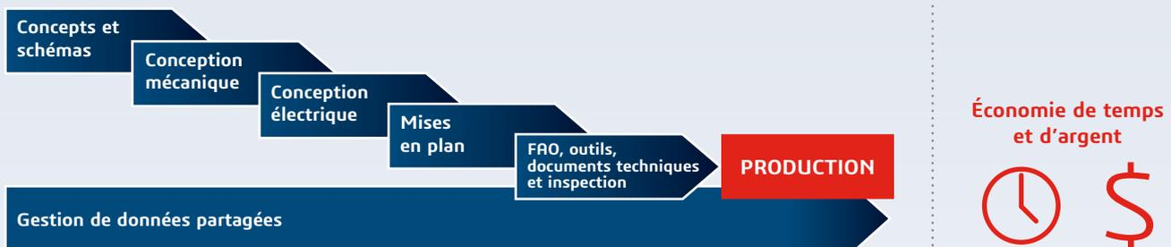
Cette solution repose sur un modèle de CAO 3D qui permet de gérer efficacement les modifications de conception ou de fabrication et de les répercuter automatiquement dans les mises en plan, systèmes de fabrication en aval et documents techniques affectés par les modifications.
