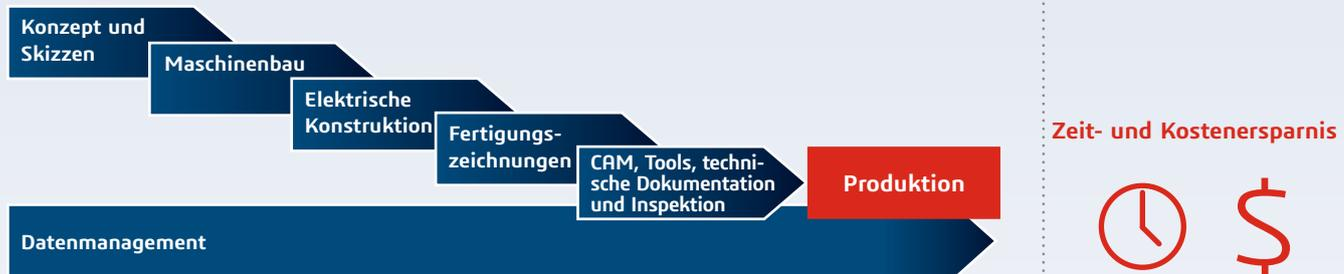
Im Zentrum dieser Lösung steht ein geteiltes 3D-CAD-Modell, das eine effektive Verwaltung von Konstruktions- und Fertigungsänderungen ermöglicht, sodass diese automatisch auf alle zugehörigen Zeichnungen und Fertigungssysteme entlang der Kette sowie technischen Dokumente übertragen werden, die von der Änderung betroffen sind.
