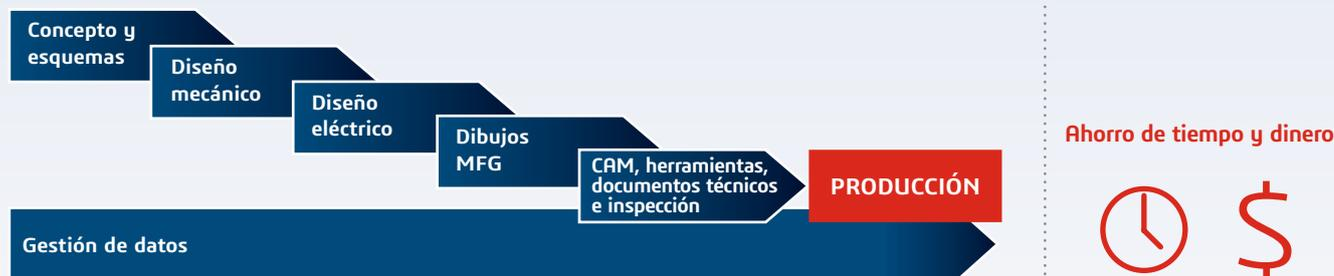
El eje de esta solución es un modelo CAD 3D compartido que permite la gestión eficaz de cambios de diseño y fabricación y su propagación automática a todos los dibujos relacionados, sistemas de fabricación subsiguientes y documentación técnica afectados por el cambio
