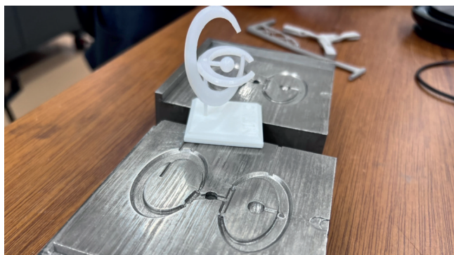
金属3Dプリンターで出力した奈良高専立体ロゴの金型。 立体ロゴおよび金型データは3DEXPERIENCE Platformで作成。
