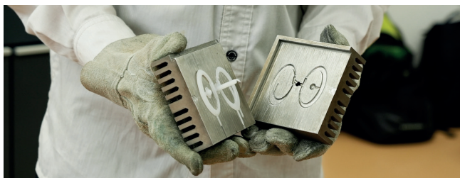
金属3Dプリンターで出力した奈良高専立体ロゴの金型。 アイデアをすぐに形にできるFABスペースの成果の一端である。
