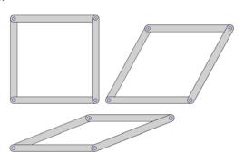
Die Sache sieht jedoch ganz anders aus, wenn Sie ein fünftes Element in diagonaler Richtung hinzufügen. Die Form ist anschließend in ihrer Position fixiert. Das zusätzliche Element zerlegt das Parallelogramm in zwei Dreiecke.
