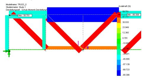
**Hinweis:** Die Axialkräfte im vertikalen Strebenelement, das den externen Lasten am nächsten liegt, sind sehr klein, da die Streben den Großteil der Last aufnehmen.
