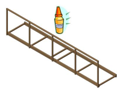
**Tipp:** Möglicherweise möchten Sie zuerst eine Seitenwand erstellen und sie mit Querverstrebungen versehen (siehe Schritt **6** auf Seite 103), bevor Sie mit der Arbeit an der gegenüber liegenden Seite beginnen.
