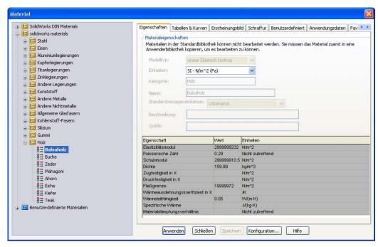
Hinweis: Das hier verwendete Material (Balsa) wurde gewählt, um die Analyse für diejenigen brauchbar zu machen, die das Tragwerk tatsächlich entwerfen, konstruieren und testen. Balsaholz ist ein übliches Material für Konstruktionsprojekte, die von Studenten durchzuführen sind.
