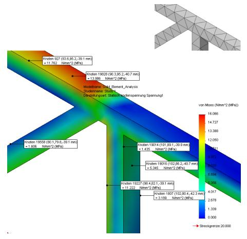
Um diese Methode zu erkunden, öffnen Sie die Teiledatei Solid\_Element\_Analysis und klicken dann auf **Simulation**, **Ausführen**. Die Ergebnisdarstellungen sind dann genau wie bei der Balkenanalyse angeordnet.
