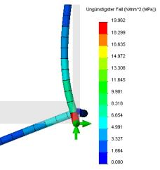
Beachten Sie, dass der Bereich mit der höchsten Spannung nicht unbedingt zum Versagen der Konstruktion führt. Folgen Sie dem Pfeilsymbol vor dem Hinweis **Streckgrenze**, um die wirkliche Schwachstelle des Modells zu ermitteln.
