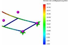
Spannungen können dazu führen, dass der Balken unter einer Last zerbricht. SolidWorks Simulation stellt farbkodierte Darstellungen zur Verfügung, in denen Bereiche mit hohen und geringen Spannungen sichtbar gemacht werden.
