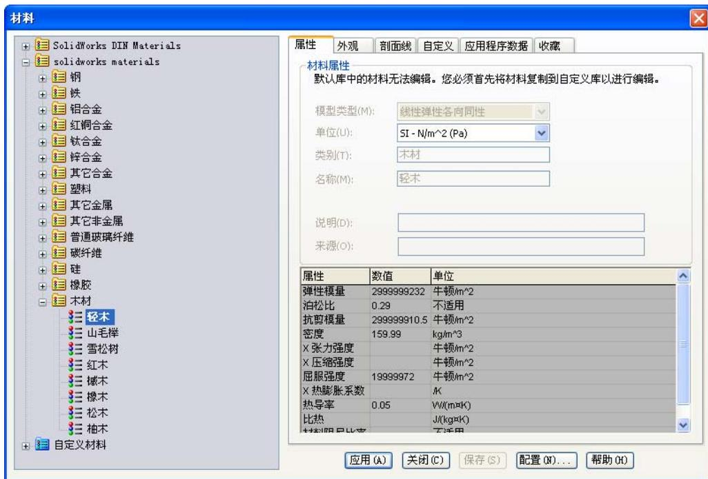
**注：** 选择材料轻木可使分析对将进行实际设计、建造并测试结构的人更具实用性。轻木是学生建造项目的常用材料。
