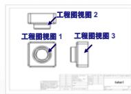
工程图窗口重新出现，带有所选零件的三个视图。
