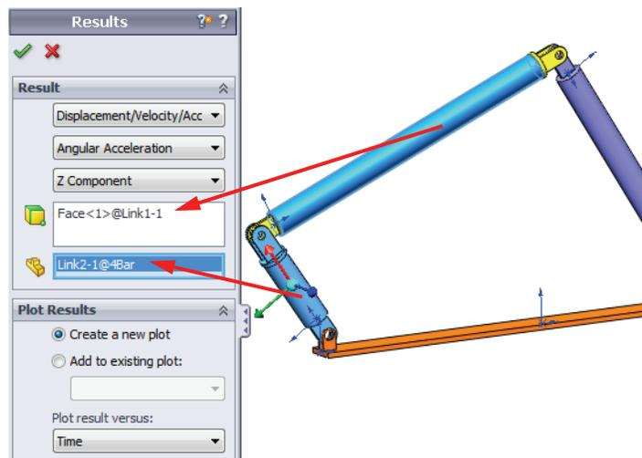
**Nota**– La terna del componente Link2 indica il sistema di coordinate locale risultante. Diversamente dal sistema di coordinate globale, che è fisso, quello locale può ruotare. In questo caso, il sistema di coordinate locale selezionato ruoterà perché il componente Link2 ruota mentre si sposta il meccanismo.
