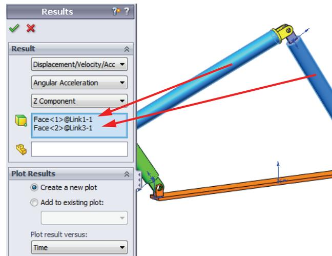
Il grafico mostra il modulo di accelerazione di Link1 (centro di massa) rispetto a Link3 (sistema di coordinate della parte). La massima accelerazione relativa è 139 gradi/sec<sup>2</sup> nella direzione Z rotazionale negativa.
