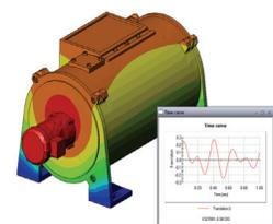
La simulazione del flusso consente di analizzare il comportamento e l'effetto di un fluido in movimento attorno e all'interno di parti e assiemi. Questa analisi tiene conto del trasferimento termico sia nel fluido che nel solido. Gli effetti di pressione e temperatura possono essere quindi trasferiti in studi SolidWorks Simulation per l'analisi della sollecitazione. Le tipiche domande cui questo tipo di analisi può dare risposta sono le seguenti:
