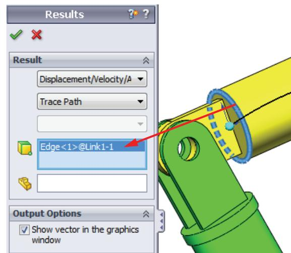
**Nota**– Il percorso risultante è mostrato di default in relazione al suolo (fisso). Per visualizzare il percorso in relazione a un altro componente in movimento, si dovrebbe selezionare il componente di riferimento come secondo elemento nello stesso campo.
