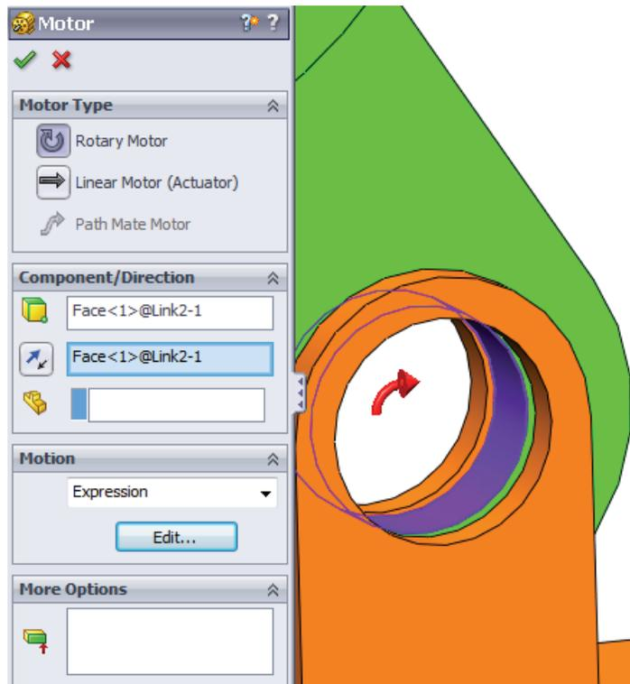
**Nota**– L'ultimo campo di **Componente/Direzione**, **Componente di riferimento**, consente di specificare il componente di riferimento per l'input di movimento relativo. Dato che abbiamo deciso di spostare **Link2** rispetto alla **Base** fissa, questo campo rimarrà vuoto.
