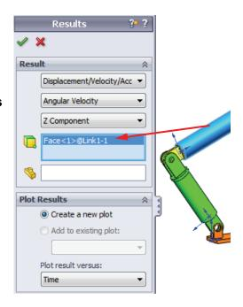
A plotagem acima mostra a variação da velocidade angular do centro de massa de Link1 em função do tempo.
