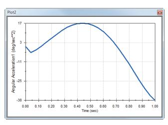
De maneira similar, crie as plotagens do **Componente Z** da velocidade angular e da aceleração angular no centro de massa de Link2 e Link3.
