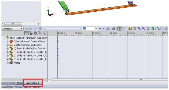
O SolidWorks Motion aproveita integralmente o SolidWorks Animator e, dessa forma, a aparência e o comportamento do SolidWorksMotionManager são muito semelhantes aos do SolidWorks Animator.
