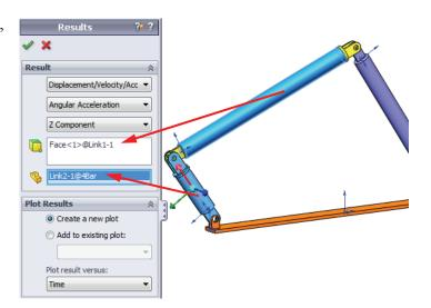
Nota: A tríade no componente Link2 indica o sistema de coordenadas local de saída. Ao contrário do sistema de coordenadas global que é fixo, o sistema de coordenadas local pode girar. Em nosso caso, o sistema de coordenadas local selecionado irá girar porque o componente Link2 gira quando o mecanismo se move
