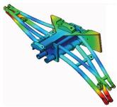
Estudos de teste de queda são usados para analisar a tensão em peças ou montagens móveis chocando-se contra um obstáculo. Perguntas típicas que serão respondidas com o uso deste tipo de estudo incluem:
