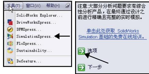
提示: 通过单击 CommandManager 中的评估选项卡上的 **SimulationXpress** 分析向导可以快速运行 SimulationXpress。
