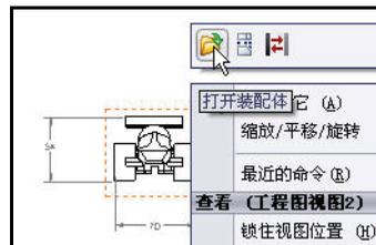
**打开装配体中的零件****1 在 Sheet2 中打开 Race Car 装配体。在前视视图中单击右键。**
