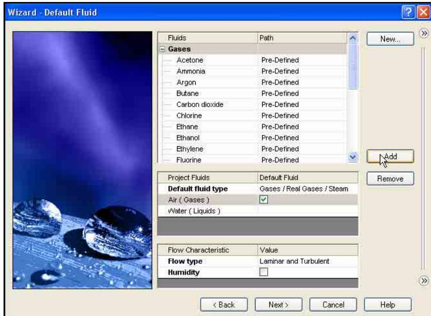
**Anmerkung:** Zu SolidWorks Flow Simulation gehört eine Datenbankbibliothek mit verschiedenen Flüssigkeiten und Gasen, die sogenannte technische Datenbank. Mit dieser Datenbank können Sie eigene Materialien erstellen.
