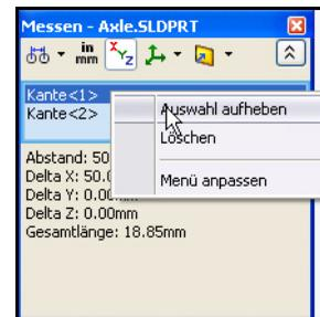
Klicken Sie auf die **Umfangslinie** von Axle<1>. Der Durchmesser beträgt 3 mm.
