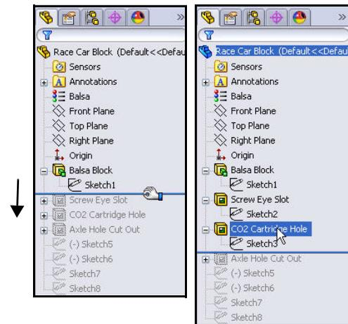
Faites glisser la **barre de reprise** vers le bas jusqu'à ce qu'elle se trouve au-dessus de la fonction Axle Hole Cut Out (Découpage de trou d'essieu). Examinez les fonctions dans la zone graphique.
