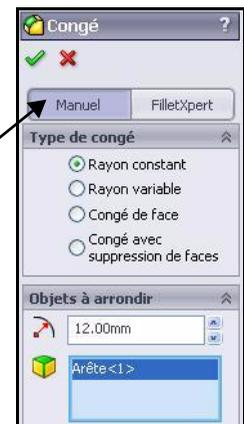
Cliquez sur l'**arête arrière** illustrée. L'arête Edge1 (Arête 1) est affichée dans la case Objets à arrondir.
