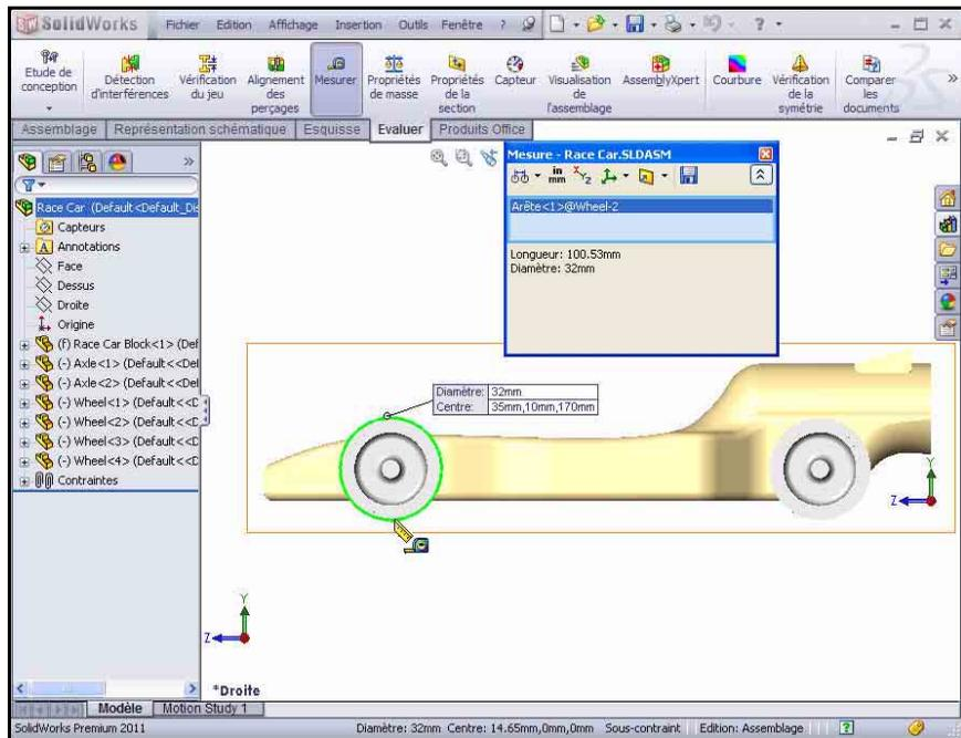
**3 Mesurer la distance entre les centres des deux moyeux de roues.**
