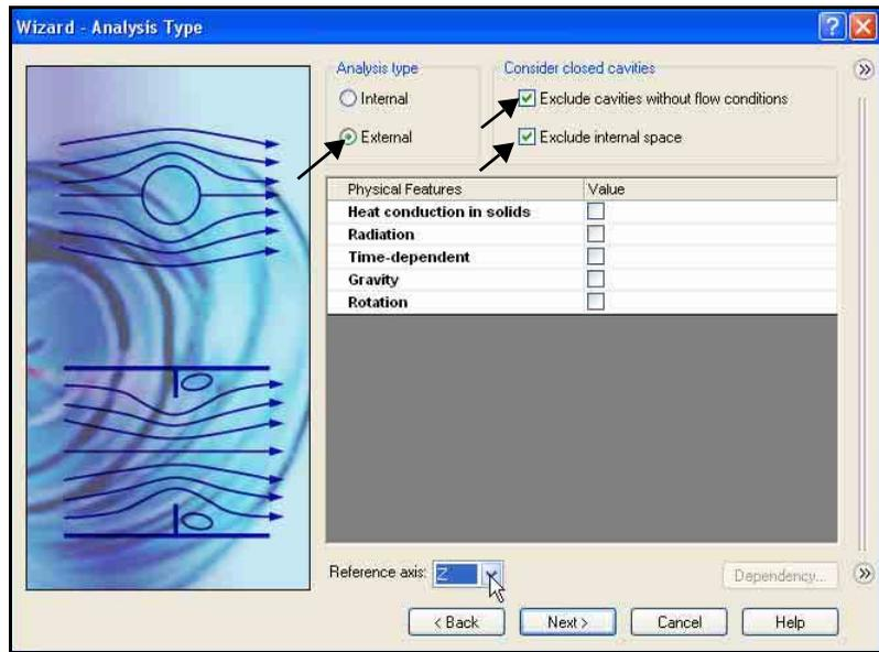
**Remarque:** Une analyse interne examine les trajectoires d'écoulement englobées alors qu'une analyse externe examine les trajectoires ouvertes. Vous pouvez, par exemple, utiliser une analyse interne pour le collecteur d'échappement d'un moteur de voiture.
