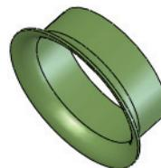
Straight Boot Section という名前の押し出しフィーチャーは runner 構成部品を intake connection boot 構成部品に接続するのに使用されます。
