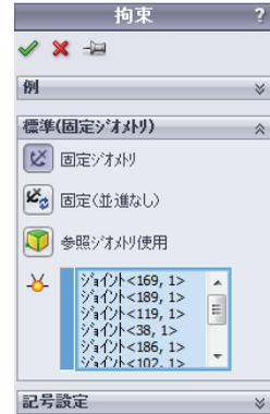
**注記：** 矢印を確認することによりどの自由度が固定されているか確認することができます。矢印は、その方向への並進が制限されていることを意味します。矢印に尾があれば、その方向を中心とした回転も制限されています。
