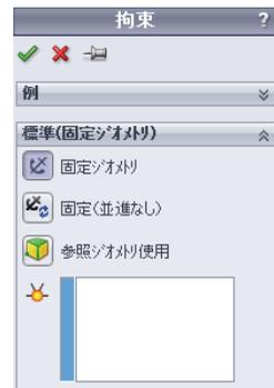
前述の通り、実験ではリアホイールは静止状態に保たれます。ねじり剛性を測定するには、荷重すべてがフレームに直接伝えられなければなりません。従って、荷重を伝える、フレームに取り付けられている部品はすべて固定と仮定しなければなりません。このケースでは、リアサスペンションが取り付けられるリアジョイントを固定するのが適切でしょう。
