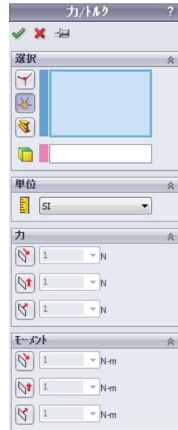
解析を簡略化するため、サスペンション構成部品を含めていません。従って実験をシミュレートするための荷重条件を定義しなければなりません。トラス部材に対する荷重の適用により、等価なトルクがサスペンション取り付け位置を通じてフレームに伝えられます。
