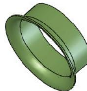
O recurso de extrusão denominado Straight Boot Section é usado para conectar os componentes de runner aos componentes de intake connection boot.
