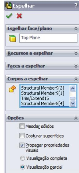
**Nota:** Espelhar os corpos *após* a aparagem elimina a necessidade de aparar os corpos espelhados.
