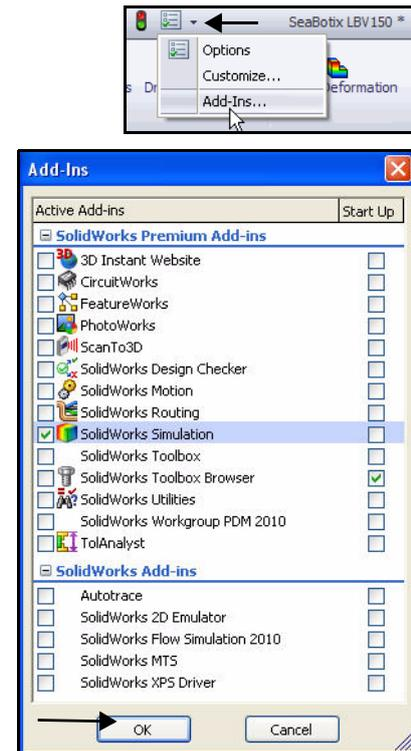
La scheda Simulation viene aggiunta al CommandManager e il pulsante Simulation viene aggiunto alla barra dei menu.
