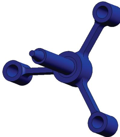
Inspeccione el modelo y busque las áreas no seguras que se muestran en rojo. Puede observarse que el trazado no tiene ninguna parte en color rojo, lo que indica que todas las ubicaciones son seguras.
