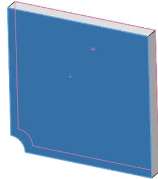
**Remarque :** Pour un maillage coque, il suffit d'imposer le déplacement d'une arête plutôt que de la face.
