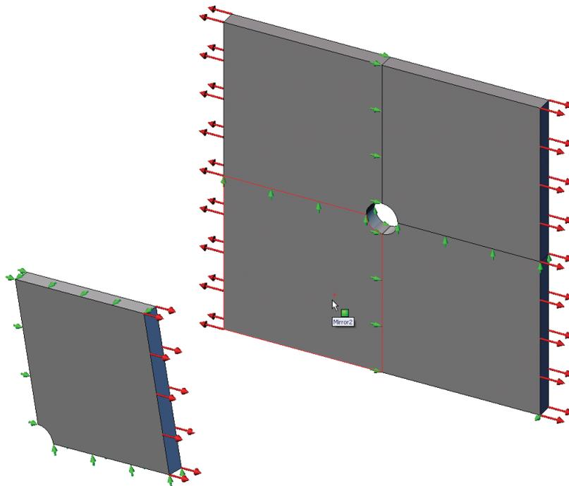
Vous allez calculer les contraintes d'une plaque carrée de 500 mm x 500 mm x 25 mm (19,68 po x 19,68 po x 0,98 po) comportant un trou de rayon de 25 mm (0,98 in) au centre. La plaque est soumise à une pression en traction de 1 MPa (145,04 psi).
