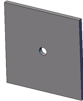
Vous allez calculer les contraintes d'une plaque carrée de 500 mm x 500 mm x 25 mm (19,68 po x 19,68 po x 0,98 po) comportant un trou de rayon de 25 mm (0,98 in) au centre. La plaque est soumise à une pression en traction de 1 MPa (145,04 psi).
