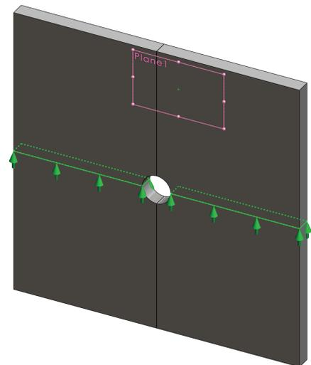
Arête<1> à Arête<8> apparaissent dans la case **Faces, arêtes, sommets pour les déplacements imposés**.
