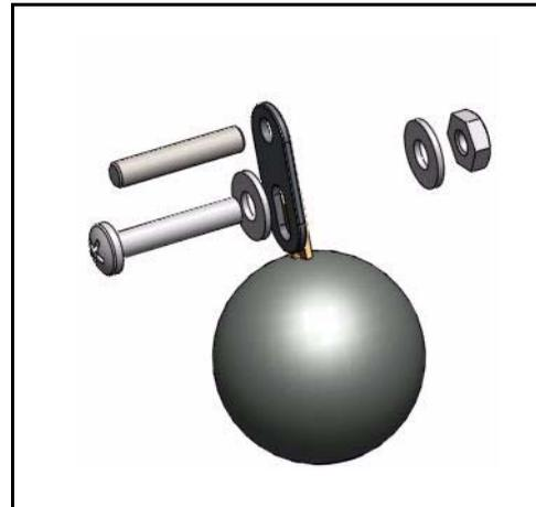
Vous allez créer une vue éclatée de l'assemblage Counter Weight. Vous allez ensuite afficher la vue éclatée dans la mise en plan de l'assemblage Counter Weight.
