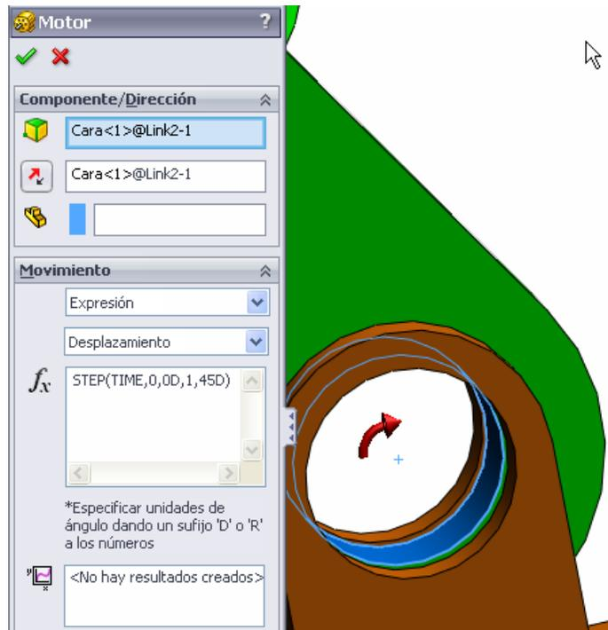
**Nota:** El último campo en el cuadro de diálogo de propiedades de **Component/Direction, Component to move relative to** (Mover componente con respecto a), se utiliza para especificar el componente de referencia para la entrada del movimiento relativo. Como deseamos mover el Link2 (Eslabón 2) con respecto a la Base fija, este campo se dejará en blanco.
