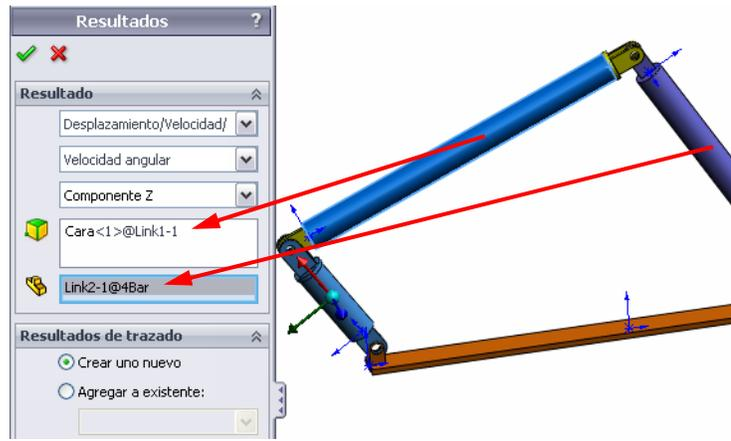
**Nota:** El sistema de referencia en el componente Link2 indica el sistema de coordenadas local de salida. Contrariamente al sistema de coordenadas global que es fijo, los sistemas de coordenadas locales pueden girar. En nuestro caso, el sistema de coordenadas local seleccionado girará porque el componente Link2 gira a medida que el mecanismo se mueve.
